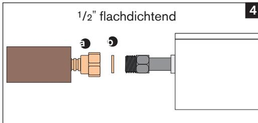
4 Beim Anschluß der Edelstahlwellrohre **a** auf den korrekten Sitz der Flachdichtung **b** achten.
