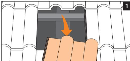
Entsprechend der Maßskizze (siehe Montagevarianten) einen Ziegel pro Sparrenanker an der entsprechenden Stelle über dem Sparren entfernen. Zur Befestigung der Sparrenanker kann jeder Sparren genutzt werden.
