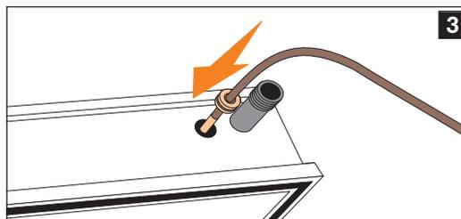
Der Fühler wird in der Tauchhülse neben dem Kollektorvorlauf an der Position (F) montiert. Dafür den Gummistopfen auf der Tauchhülse abziehen und Kabel vorsichtig durch den Stopfen führen. Anschließend den Fühler in die Tauchhülse am Kollektor vollständig bis zum Anschlag einführen und den Gummistopfen wieder im Kollektorgehäuse einmontieren.
