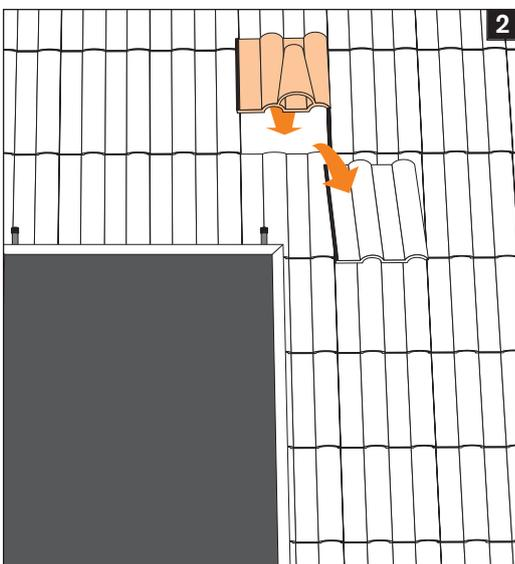
Oberhalb des Vor- und Rücklaufs des Kollektorfeldes jeweils einen Dachziegel gegen einen Lüftungziegel austauschen. Dabei muss darauf geachtet werden, dass die Verlegung des flexiblen Edelstahlwellrohres steigend erfolgt und so eine Entlüftung am höchsten Punkt möglich ist.
