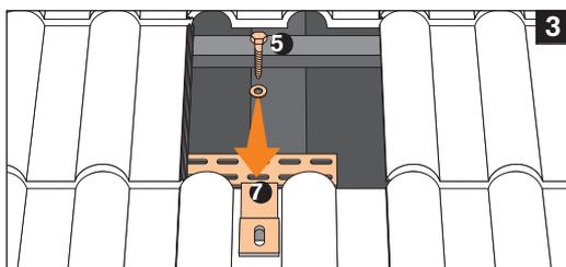
Die Sparrenanker 7 mit einer Wasserwaage horizontal ausrichten und mit Holzschrauben und Unterlegscheiben 5 montieren. Bis zu drei Schrauben können pro Sparrenanker verwendet werden.
