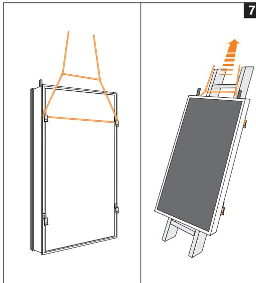
Kollektoren mit Hilfe eines tragfähigen Seils auf das Dach bringen. Dazu das Seil nur an den oberen Quickies befestigen, wenn diese sehr fest verschraubt sind. Ansonsten besteht die Gefahr, dass die Quickies seitlich wegdrehen und der Kollektor herunterfällt. Besser ist die Befestigung eines Seils um den ganzen Kollektor, der dann über eine Leiter auf das Dach gezogen werden kann. Niemals das Seil an den Kollektoranschlüssen anbringen.
