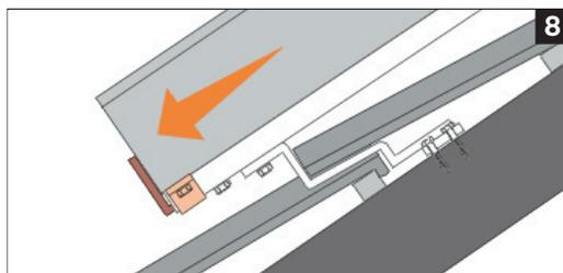
Den Kollektor auf das Gestell heben und bündig an die L-Stoppprofile schieben.
