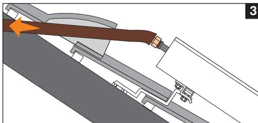
3 Bei der Montage des Entlüfters unter dem Dach wird zunächst das flexible Edelstahlwellrohr (900 mm) durch den Entlüfterziegel geführt.
