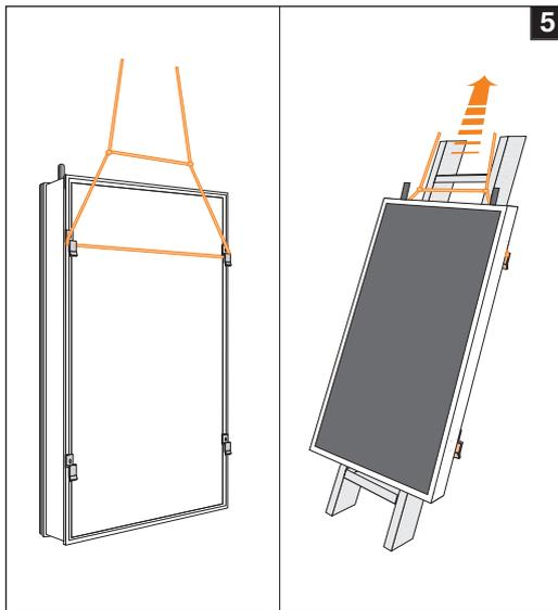
**5** Kollektoren mit Hilfe eines tragfähigen Seils auf das Dach bringen. Dazu das Seil an den oberen Quickies befestigen und die Kollektoren über eine Leiter auf das Dach ziehen. Niemals das Seil an den Kollektoranschlüssen anbringen.
