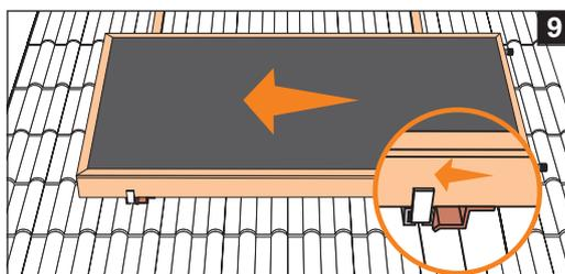
Den Kollektor seitlich mit den Quickies auf die C-Profilschiene schieben.
