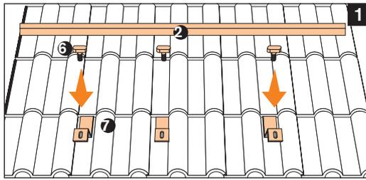
Das C-Profil **2** mit Hammerkopfschrauben **3** (M10x30) auf die Sparrenanker montieren. Achtung: Im Bereich der Sparrenanker können die Quickies **4** zur Kollektorbefestigung nicht in die Schiene einrasten. Deshalb die Sparrenanker **7** nicht mittig zwischen zwei Kollektoren montieren.
