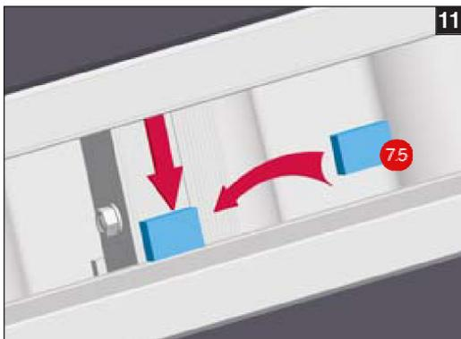
Abstandhalter mit Anschlag gegen den ersten Kollektor auf die Profilschiene aufkleben. Entsprechend Unterpunkt 9 und 10 einen weiteren Kollektor montieren. Dieser Kollektor muß an den Abstandhaltern anliegen.
