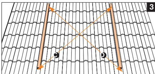
Die Schienen sind parallel ausgerichtet, wenn Maß C = D (z.B. mit Schnur vermesen). Bei korrekter Ausrichtung können die Schienen fest verschraubt werden.
