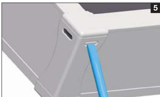
Entsprechend der Montage auf dem Dach an beiden unteren Kollektorecken jeweils beide Entwässerungslöcher mit Hilfe eines Schlitzschraubenziehers ausbrechen. Dabei an der Unterkante ansetzen. Um zu gewährleisten, dass sich der Kollektor entwässern kann, ist es unbedingt notwendig, dass alle Entwässerungslöcher unten (entsprechend der Orientierung auf dem Dach) ausgebrochen sind!!
