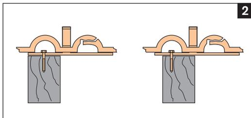
Durch die breite Befestigungsleiste am Sparrenanker ist gewährleistet, dass der Durchgang des Sparrenankers immer im Ziegeltal erfolgen kann.
