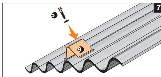
Auf Dächern mit Wellplatten Sparrenanker auf den Wellenberg setzen und durch den Belag mit dem Sparren verschrauben. Die Bohrung in der Welldachplatte muß vor Eindringen von Feuchtigkeit abgedichtet werden.
