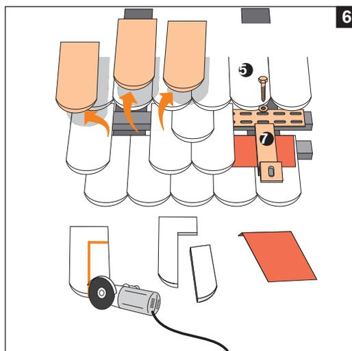
Bei der Sparrenankermontage bei Biberschwanzeindeckung müssen mehrere Ziegel pro Sparrenanker entfernt werden. Der Sparrenanker wird auf der Dachlatte befestigt, wobei zusätzlich ein Blech (nicht im Lieferumfang) unter den Anker gelegt werden muss. Auch hier wieder die Hakendurchführung ausschneiden.
