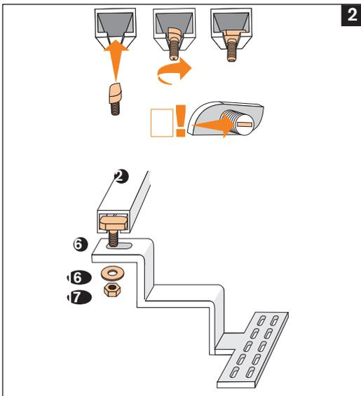
Einführen der Hammerkopfschraube in das C-Profil und bis zum Anschlag drehen. Durch die Kerbe am Gewindeende kann die korrekte Position der Schraube überprüft werden.
