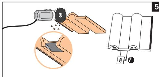
Die Dachziegel müssen im Bereich der Sparrenankerdurchführung an ihrer Unterseite mit Hilfe eines Winkelschleifers mit Steinscheibe ausgespart werden. Anschließend den bearbeiteten Ziegel wieder einsetzen.
