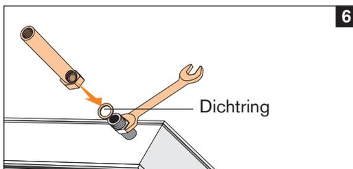
6 Bei der Montage des Entlüfters auf dem Dach muss zunächst das T-Stück mit vormontiertem Entlüfter auf den Kollektorfeldanschlüssen befestigt werden (sowohl im Voral als auch im Rücklauf). Zwischen Kollektor und T-Stück muß eine Dichtung eingelegt werden.
