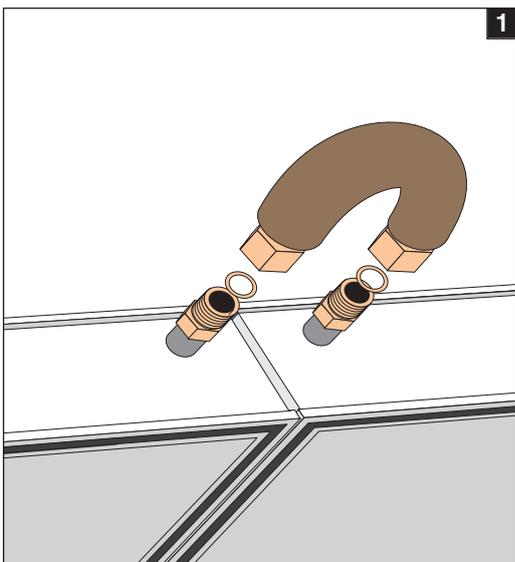
Die Verbindung der Kollektoren untereinander erfolgt mit den kurzen Edelstahlwellrohren **1** (300 mm). Hierbei auf den korrekten Sitz der Flachdichtung achten.
