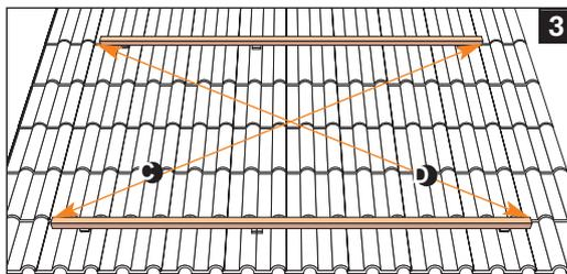
Die Schienen sind parallel ausgerichtet, wenn Maß C = D (z.B. mit Schnur vermessen). Bei korrekter Ausrichtung können die Schienen fest verschraubt werden.
