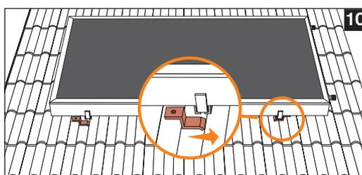
Quickies auf der Seite der Kollektoranschlüsse lösen und einen um 180° drehen. Quickies auf der gegenüberliegenden Seite in die C-Schiene einrasten lassen und gelöste Quickies wieder fest montieren.
