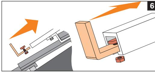
Vor der Kollektormontage wird das L-Stoppprofil ⑩ in die untere Öffnung der C-Profile gesteckt und mit Hammerkopfschrauben befestigt.
