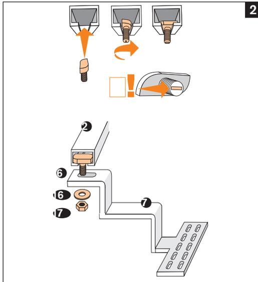
Hammerkopfschraube in das C-Profil einführen und bis zum Anschlag drehen. Durch die Kerbe am Gewindeende kann die korrekte Position der Schraube überprüft werden bzw. mit Hilfe des Schraubendrehers in die richtige Position gebracht werden.
