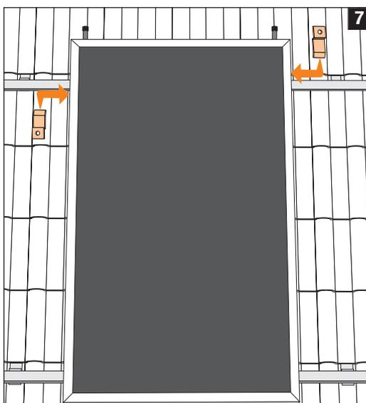
**7** Die oberen Quickies wieder lösen. Einen dieser Quickies von oben und einen von unten über die obere C-Profil-Schiene schieben und fest verschrauben.
