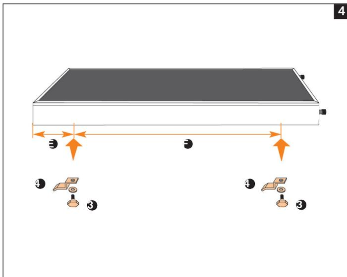
Montage der Quickies **4**. Beachten Sie die Maße (E) und (F). Das Maß (E) sollte nicht größer als 50 cm sein, das Maß (F) sollte 5 cm größer als der Abstand der Profilschienen sein. Dies erleichtert die spätere Montage auf dem Dach. In der Montageut des Kollektors befinden sich Nutsteine M8.
