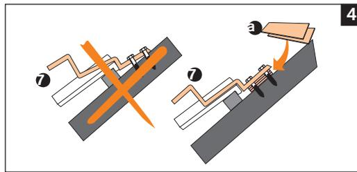
Beachten Sie, dass der Sparrenanker **7** nicht auf den Dachziegeln aufliegt. Ansonsten besteht die Gefahr, dass diese bei starkem Winddruck beschädigt werden. Gegebenenfalls sollte der Sparrenanker mit Ausgleichshölzern **3** unterfüttert werden.
