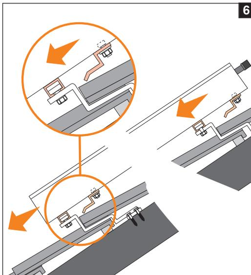
**6** Kollektoren mit den unteren Quickies in die C-Schiene einrasten lassen. Anschließend die Kollektoren seitlich ausrichten.
