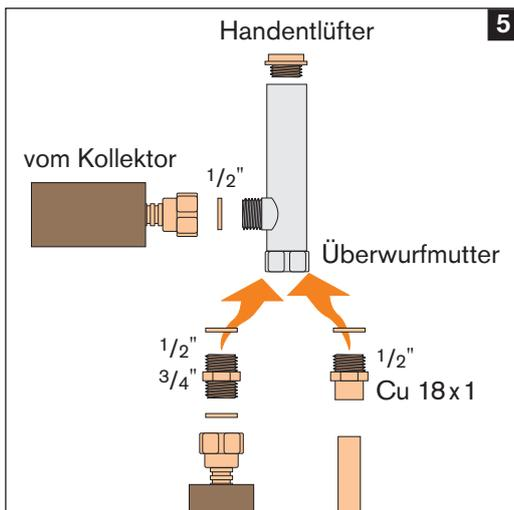
5 Das T-Stück mit Entlüfter wird an dem Flexrohr unter dem Dach montiert. Der Übergang vom T-Stück zur weiteren Verrohrung erfolgt über einen Lötnippel (für Cu-Rohr) bzw. einen Reduziernippel (bei Einsatz von Flexrohr).
