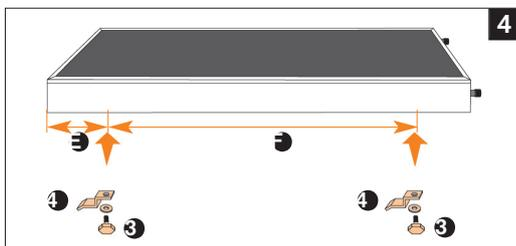
Montage der Quickies ❹. Beachten Sie die Maße (E) und (F). Das Maß (E) sollte nicht größer als 50 cm sein, das Maß (F) sollte 5 cm größer als der Abstand der Profilschienen sein. Dies erleichtert die spätere Montage auf dem Dach. In der umlaufenden Montage des Kollektors befinden sich Vierkantmuttern, die mit Hilfe eines Schraubendrehers (o.ä.) in die richtige Position gebracht werden müssen.
