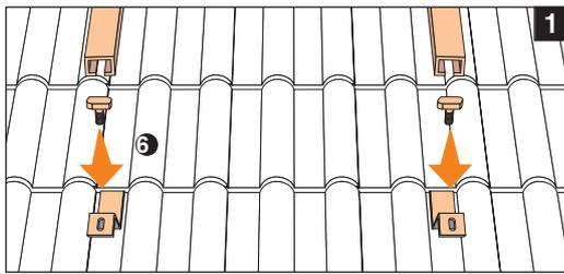
Das C-Profil mit Hammerkopfschrauben ❸ auf die Sparrenanker montieren. Achtung: Im Bereich der Sparrenanker können die Quickies zur Kollektorbefestigung nicht in die Schiene einrasten. Deshalb die Sparrenanker nie mittig zwischen zwei Kollektoren montieren.
